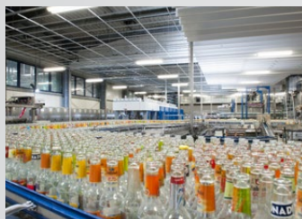
Línea de llenado de retornables
